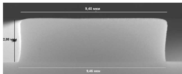
Вертикальные края, высокая доза экспонирования, высокая температура термообработки
