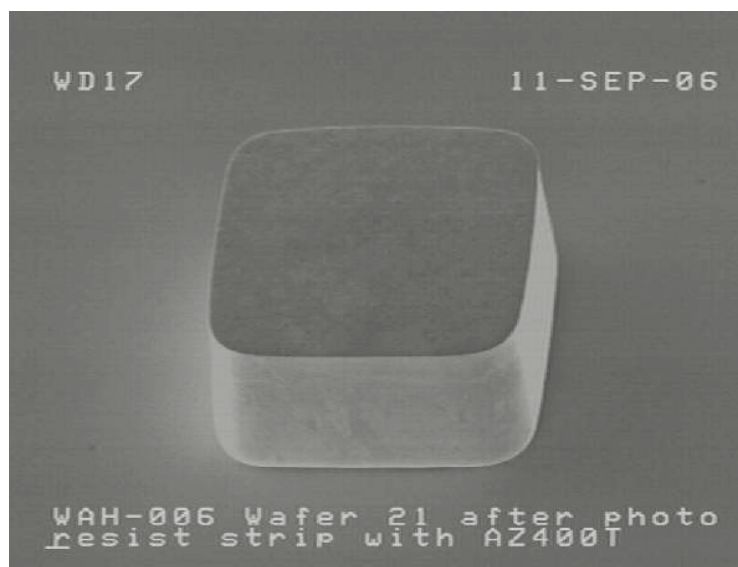
Снятие фоторезиста с золотых площадок Ширина: 40 мкм Высота: 35 мкм
