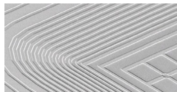
AR-P 3500 Толщина пленки 2 мкм Структуры резиста 5 мкм
