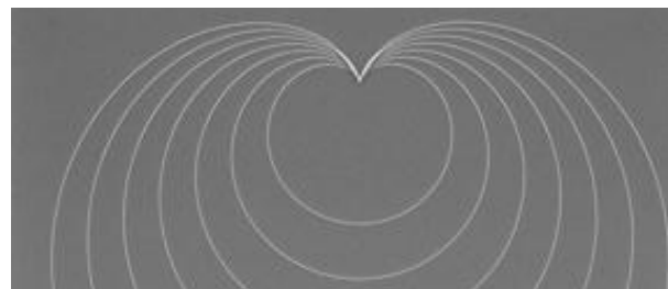
Рис. 3 Структуры из хрома с линиями 20 нм после взрывной литографии
