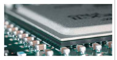
Характеристики полупроводникового прибора в сильной степени определяются состоянием его поверхности. Внешняя среда оказывает существенное влияние на качество поверхности и, соответственно, на стабильность параметров прибора. Данное воздействие изменяется в процессе эксплуатации, поэтому очень важно защитить поверхность прибора для увеличения его надёжности и срока службы.
