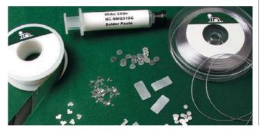
• Индийсодержащие сплавы. В чистый Индий иногда добавляют Свинец, Олово или Серебро для увеличения механической прочности или изменения температуры плавления.
