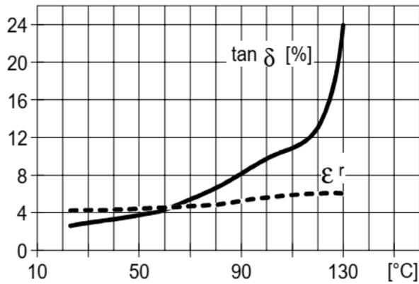
Изменение тангенса угла и диэлектрической постоянной от температуры (50 Гц, IEC 60250)
