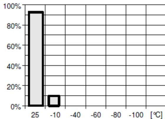
Результаты испытания компаунда на термический шок (без содержания пластификатора)
