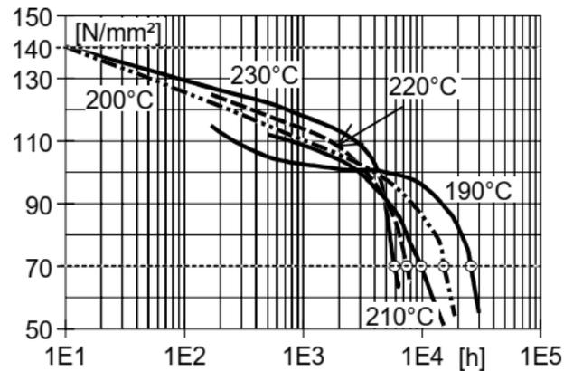
Изменение усилия на изгиб в зависимости от времени при разных температурах (ISO 178, предел 50%)
