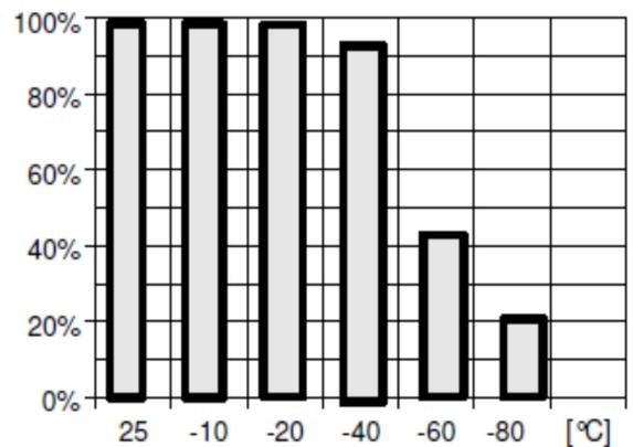
Результаты испытания компаунда на термический шок (Пластификатор - 20 м.д.)
