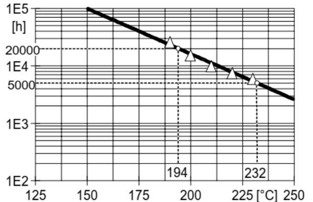
Температурный индекс (смола: отвердитель: ускоритель:наполнитель -100:85:0.8:345 м.д.)
