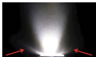
Рисунок 4. Изображения луча света у классической (слева) и у новой (справа) конструкции коллиматора LEDnLIGHT. В качестве источника света применялся бескорпусный чип CREE с мощностью 42 В / 350 мА.
