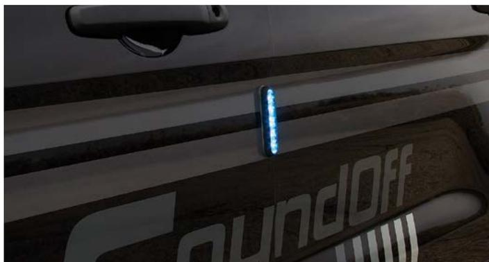
mPOWER Fascia Light от компании SoundOff Signal — это первый чрезвычайно компактный, трехцветный световой для автомобилей экстренных служб на рынке. Прозрачная линза изготовлена из пластичного силикона DOWSIL™ MS-1002. Затем линза покрывается цветным пластичным силиконом DOWSIL™ MS-0002 для бесшовного формирования корпуса линзы.
