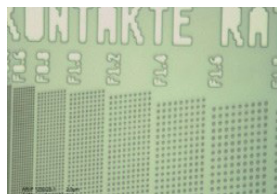
AR-P 1220 Толщина пленки 3,5 мкм Разрешение до 1,2 мкм
