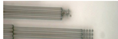
Разрешение при толщине пленки 5 мкм: 1,6 мкм
