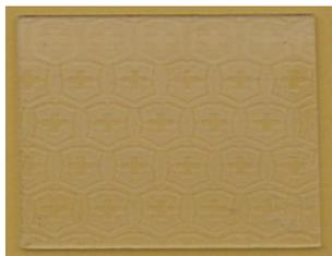
Двухслойное структурирование с помощью SX AR-PC 5000/40 и AR-P 3250 (сверху – резистный шаблон, снизу – после травления на стекле)
